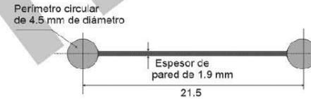
Especimen de ensayo: Tipo I moldeado con el compuesto plástico que se solicita en la producción de la asa.
