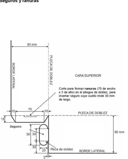
Corte para formar ranuras (70 de ancho x 3 de alto) en el pliegue de doblez, para insertar seguro cuyo cuello mide 30 mm de largo.
